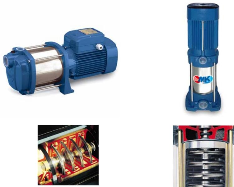
Это даёт возможность получить высокий КПД и относительную бесшумность при работе. Многоступенчатые насосы могут быть вертикального или горизонтального исполнения. Нормальновсасывающие, **манометрическая высота всасывания таких насосов до 7** или самовсасывающие, **манометрическая высота всасывания таких насосов до 9 метров** Температура перекачиваемой среды 40-90°C зависит от материала изготовления рабочей камеры и крыльчатки.
