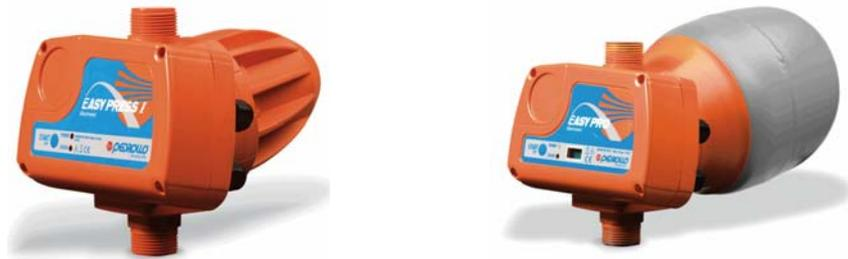
Электронное устройство для запуска и остановки небольших однофазных электронасосов при открытии и закрытии водопроводного крана. У всех электронных регуляторов принцип работы одинаковый, они могут отличаться по конструкции и возможности изменения давления включения.
